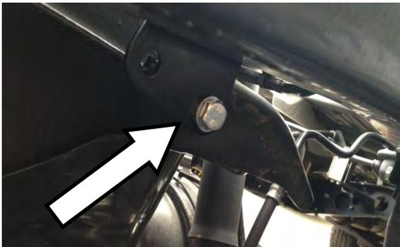
5. ATTACH THE ORIGINAL BRAKE HOSE BRACKET TO THE NEW OME DROP BRACKET. USE THE M8 BOLT, NUT AND WASHERS PROVIDED. TIGHTEN HAND TIGHT.
