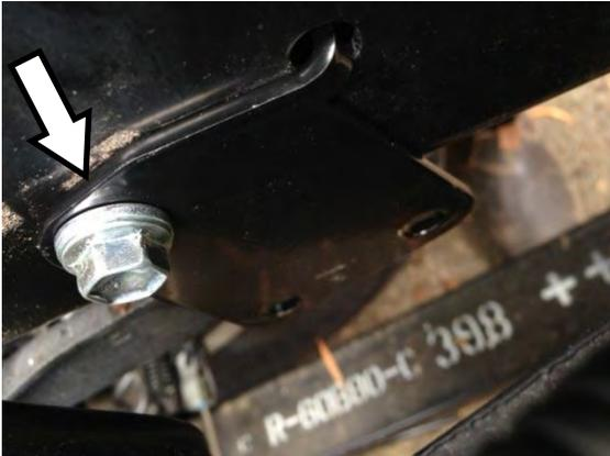
3. RE- USING THE ORIGINAL BOLTS, ATTACH THE OME LC70 REAR BRAKE HOSE DROP BRACKET (LARGER BRACKET) TO THE CHASSIS
