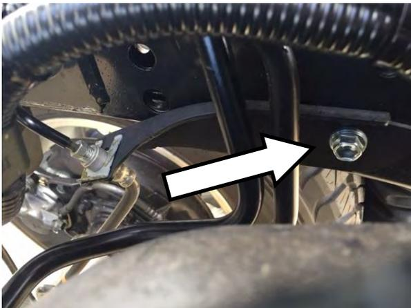
1. DISCONNECT THE REAR BRAKE HOSE BRACKET FROM THE CHASSIS.
