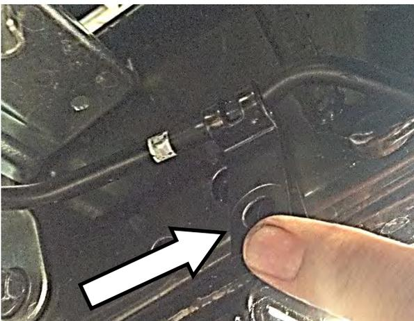
2. DISCONNECT THE BRAKE HARD LINE BRACKET FROM THE CHASSIS.
